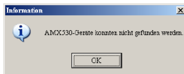
Bild 41. Fehlermeldung bei Port-Suche
